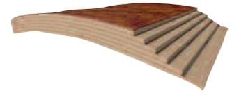
Конструкция корпуса из шести асимметричных слоев демпфированного ламината - Damped Asymmetric Hex Laminate Isolation (DAHLI)
